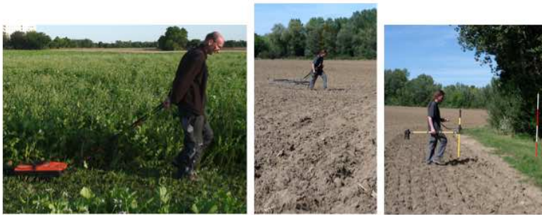
Abb. 7. Im Projekt Mutterstadt eingesetzte Messsysteme (von links): Bodenradar (Transient Technologies VIY3-300, 300 MHz-Antenne), Impuls-Elektromagnetik (EBINGER UPEX 740 M), Geomagnetik (Gradiometer EBINGER MAGNEX 100 B mit EDAD Digitalsystem).
